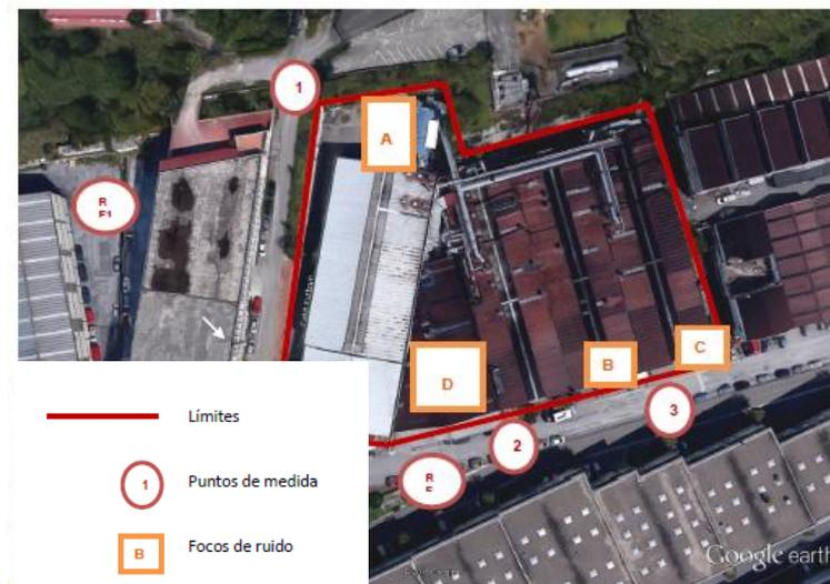
**Foto nº 2:** Imagen que muestra los focos de ruido y los puntos de muestreo (Fte: Estudio de contaminación acústica)
