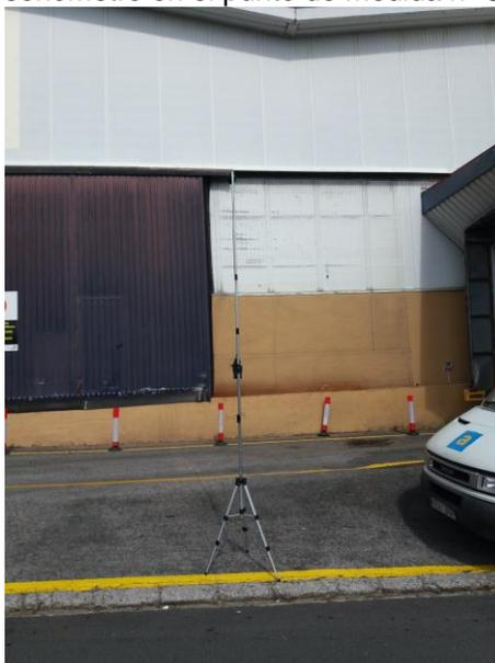
En todos los puntos la altura del micrófono ha sido de 4 metros. En el anexo II se muestra un croquis de la ubicación de los puntos donde se han llevado a cabo los ensayos y las fuentes de ruido de la actividad.
