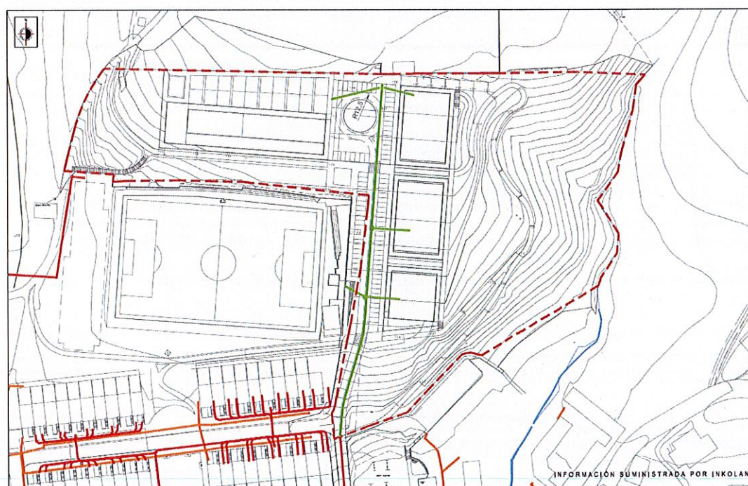
IMAGEN DEL ESTADO REFORMADO DE LA RED DE SUMINISTRO DE TELEFONIA ..... VER PLANO B.2.2.4
